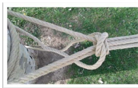
Imagen 4. Ballestrinque para tensado final.
